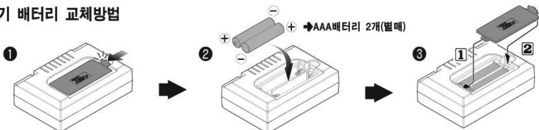
①화살표 방향으로 배터리 커버를 밀면서 열어주세요.      ②새 배터리를 넣어주세요.      ③그림처럼 번호순서대로 배터리 커버를 닫아주세요.
