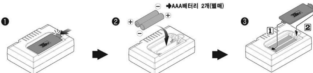
①화살표 방향으로 배터리 커버를 밀면서 열어주세요.    ②새 배터리를 넣어주세요.    ③그림처럼 번호순서대로 배터리 커버를 닫아주세요.
